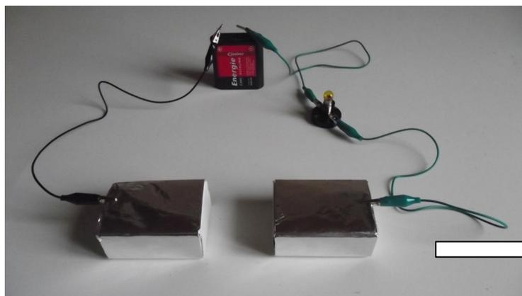
1. On place le montage pile-fils-ampoule-boîtes d'allumettes recouvertes de papier d'aluminium dans notre boîte aux lettres.
